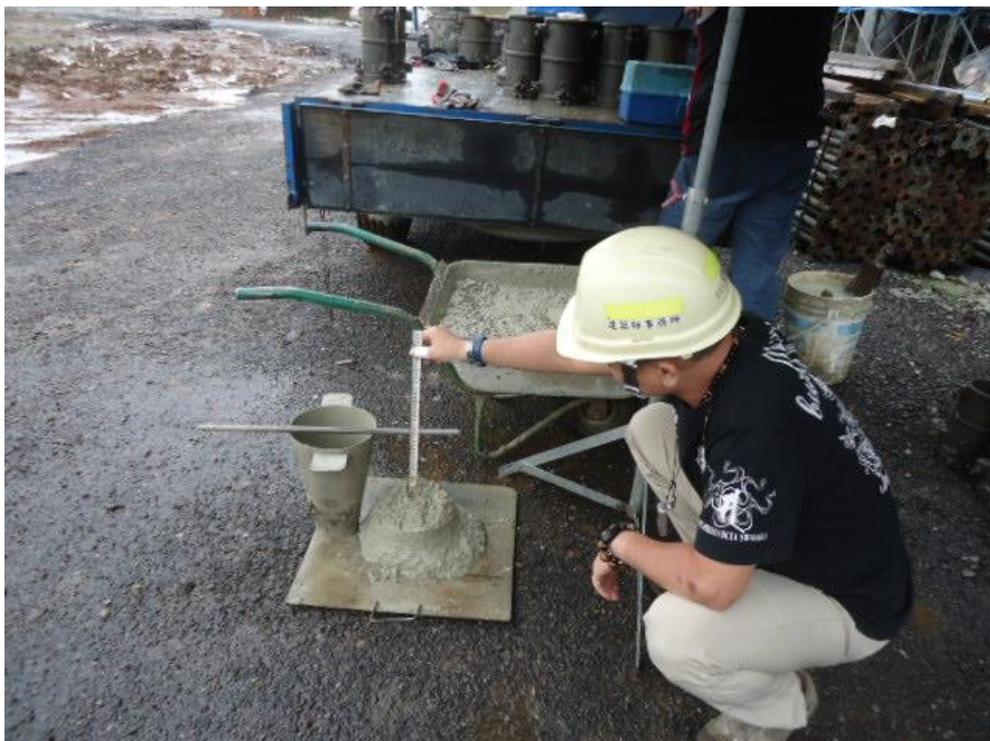
照片說明:H棟屋頂版澆置灘度測試
